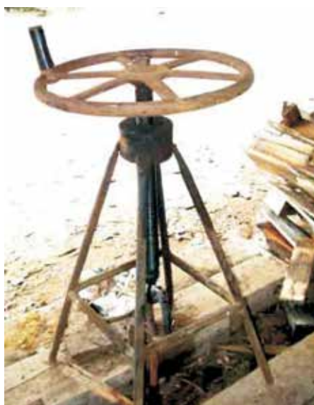
Figura 187 - Válvula do canal para a Chaminé. Olaria Vila Real, Porto Real. Fonte: Isabel Rocha, 2009.
