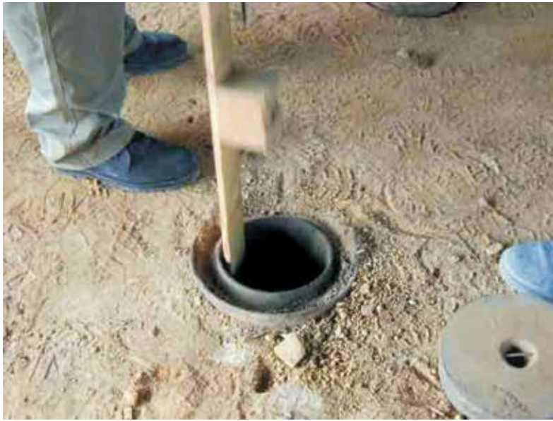
Figura 184 - Colocando a lenha na boca do fogo. Olaria São Sebastião, Barra do Pirai. Fonte: Isabel Rocha, 2009.
