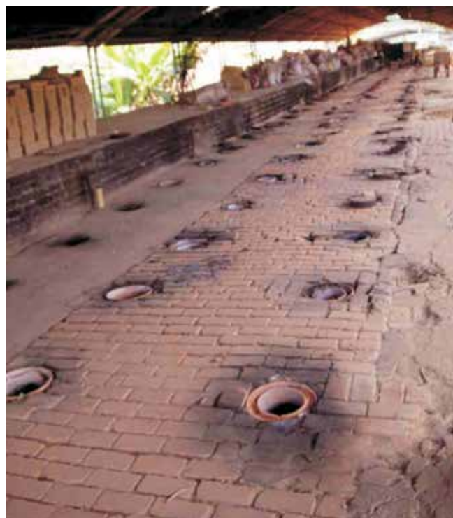
Figura 183 – Teto do forno com as bocas de fogo. Olaria C Vaz, Paraíba do Sul. Fonte: Isabel Rocha, 2009.
