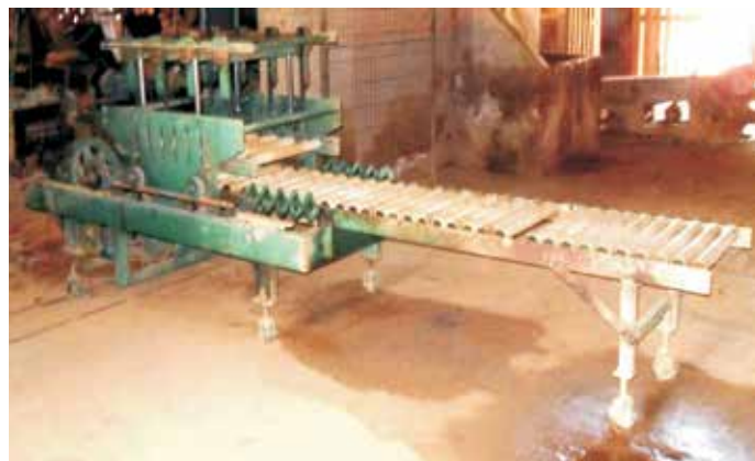
Figura 169 - Laminador da Cerâmica Graça e Filhos, Vassouras, RJ. Foto: Raoni, Rafael e Laura, CAUVR-UGB, 2009.
