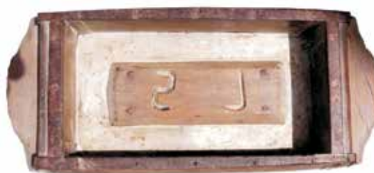
Figura 228 – Molde para tijolo impresso. Faz. da Prosperidade, Barra do Pirai.
