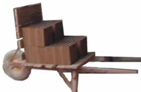
Figura 138 - Carrinho para transporte de tijolos. Olaria Saldanha, Paraíba do Sul. Fonte: CAUVR-UGB, 2009.
