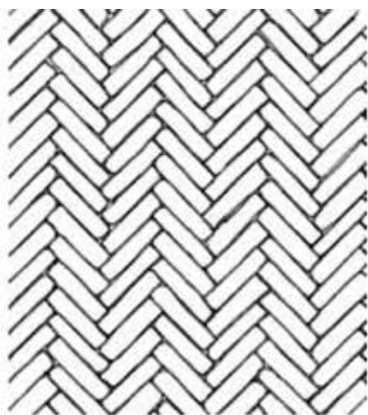
Figura 94 – Aparelho em espiga ou espinha, opus spicatum.
